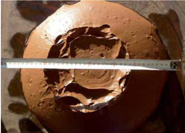
Relleno sin aditivo
